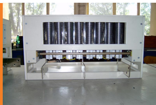
Составной блок с полупроводниковыми деталями, охлаждаемые тепловыми трубками ALTRA
